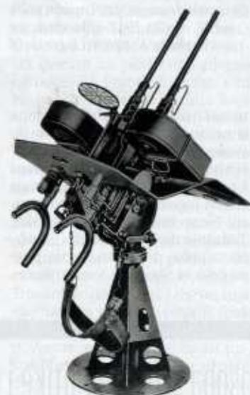
Par teških strojnica M2 na protuzračnom kružnom postolju. Na sličnom principu na jednako postolje postavljane su i četiri strojnica M2. S takvim strojnicama, uz trupnu obranu, naoružavani su brodovi i vozila
